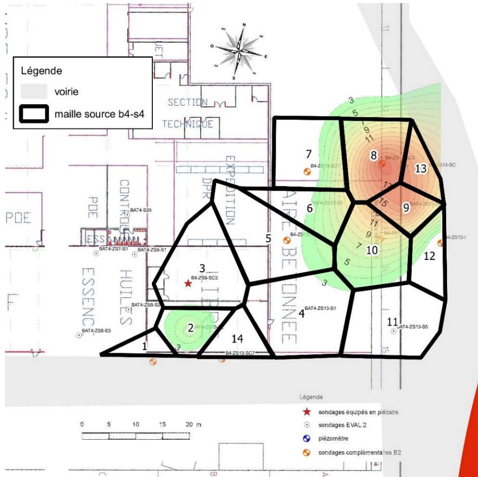
Superposition modifiée de l'approche cartographique et bilan massique pour la source B4-S4 – horizon 0,2-1,6 m
